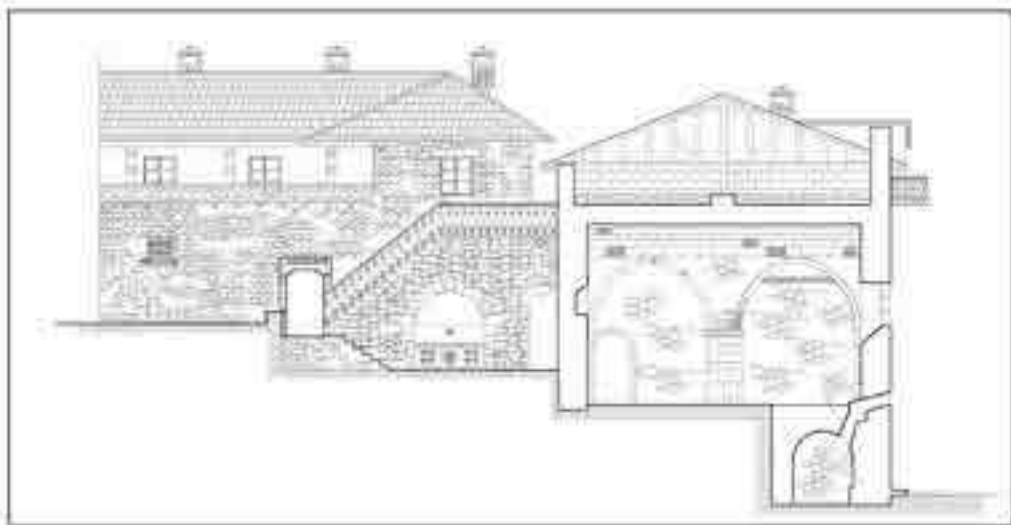
Монастырь Сурб Хач. Атриум и разрез трапезной (авт. — М. В. Петросян).
