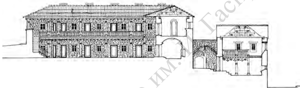
Продольный разрез южного крыла монастыря через дворик обители (авт. реконструкции – М. В. Петросян).
